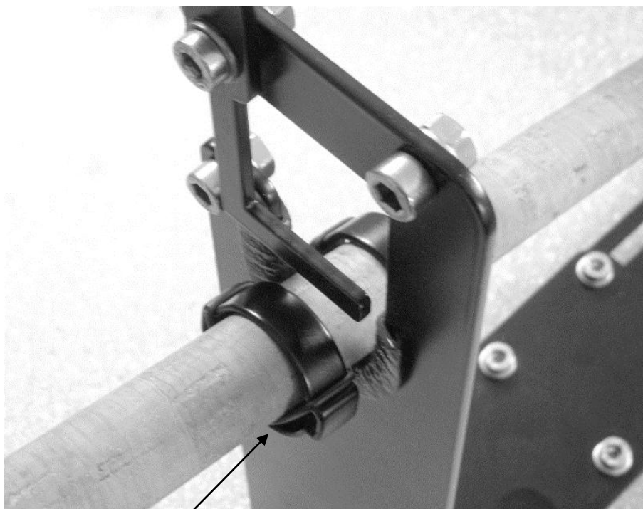
O-Ring gemäss Abbildung montieren.
